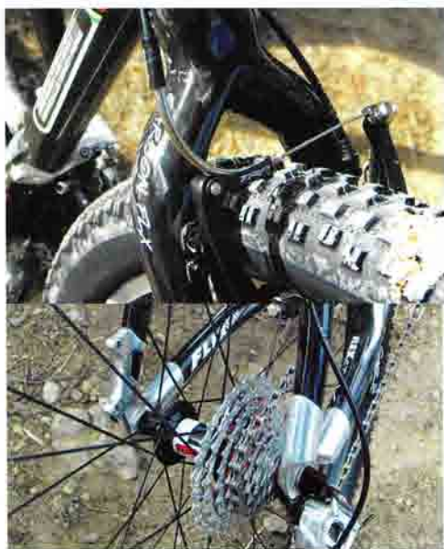
Dvě momentky z nového týmového MTB rámu: Masivní monostay zadní stavby zajistí její tuhost, zploštění nohou vidlice pak dodá komfort (obrázek vlevo).
