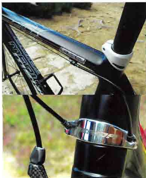
Nová objímka sedlovky i uchycení bovdenů na hlavovou trubku – vše po vzoru nových trendů.
